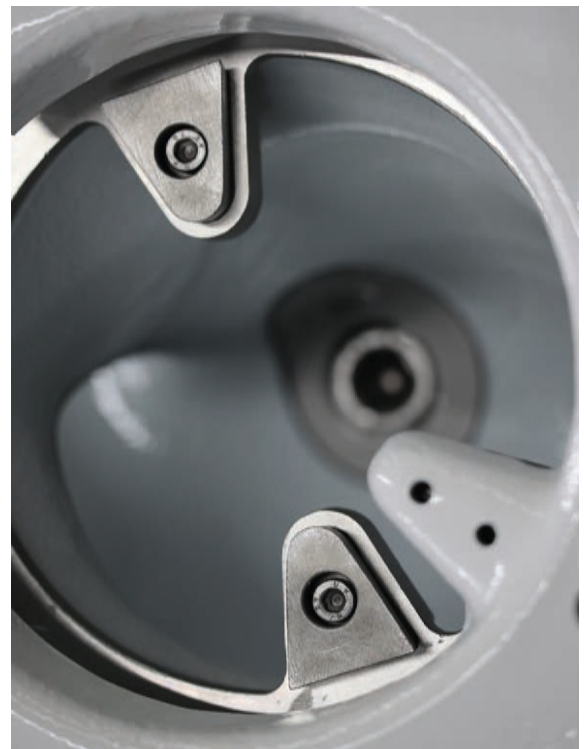
Austauschbare Hartmetall-Schneidplatte (HRC 55) des ASC-Systems.
