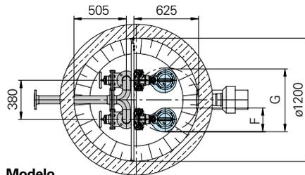
**Instalación en un pozo con sistema de acoplamiento automático**
