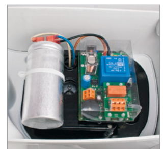
Die im Trockenbereich des Behälters untergebrachte Elektronik steuert und überwacht die Anlage.
